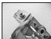
Odetnij końcówki elementu zgrzewającego. Przyklej mocno taśmę teflonową do listwy w taki sposób, by nie powstały na niej żadne zagniecenia.
