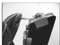
Przeciagnij przewody przy pomocy szczypców i przykręć śrubę
