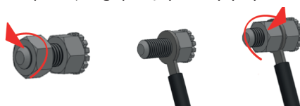
Rys. 4. Podłączenie urządzenia do instalacji wyrównującej potencjały elektryczne.
