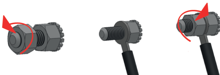
Rys. 7. Podłączenie urządzenia do instalacji wyrównującej potencjały elektryczne.
