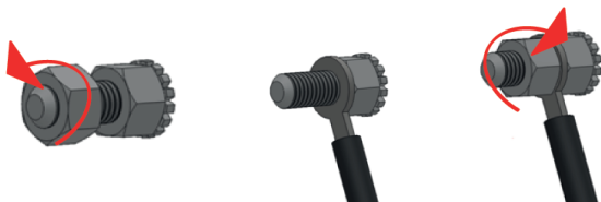
Rys. 4. Podłączenie urządzenia do instalacji wyrównującej potencjały elektryczne.
