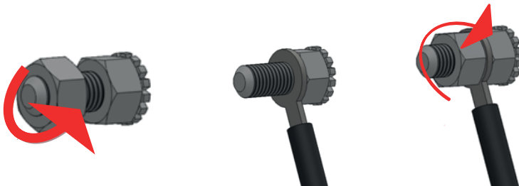
Rys. 3. Podłączenie urządzenia do instalacji wyrównującej potencjały elektryczne.
