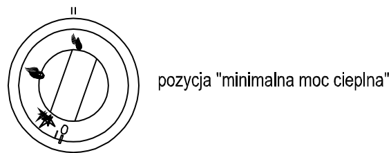
Rysunek 3 - Pokrętko kurka palnika gazowego z zapalaczem piezoelektrycznym
