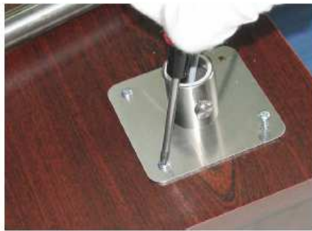
c) Przykręcenie podstawki miernika
