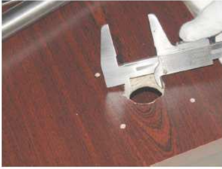
a) Wykonane otwory pod montaż miernika
