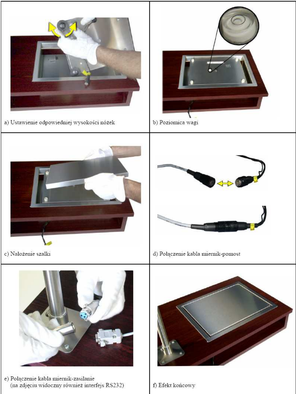
Rys. 9. Przykład umieszczenia pomostu wagi oraz połączenie kabli modułów
